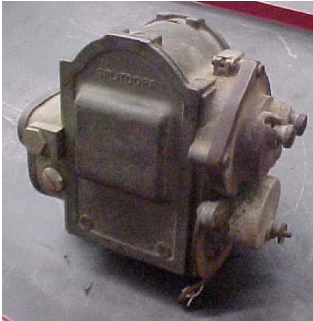
Splitdorf 246T with EM Impulse Unit
